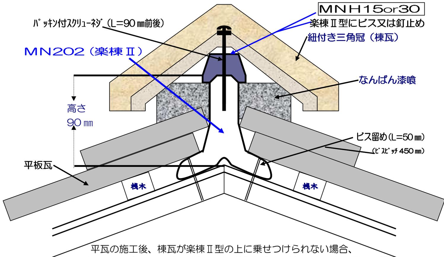
平瓦の施工後、棟瓦が楽棟Ⅱ型の上に乗せつけられない場合、楽棟ハット (MNH15or30) を楽棟Ⅱ型に乗せ、ビス又は釘にて仮止め固定し、棟瓦の所定穴からパッキン付ネジで楽棟ハットを貫通し、楽棟Ⅱ型に 30 mm 以上差し込みしっかりと留め付ける。
